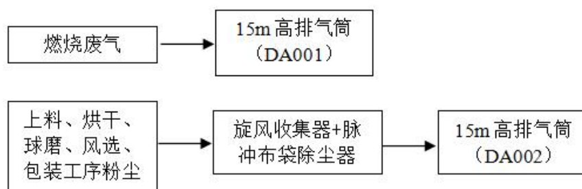
图 4-2 废气处理流程图
