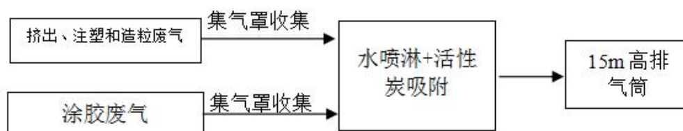
图 4-2 有机废气处理流程图
